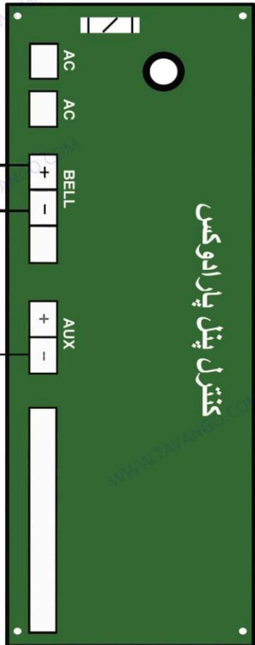
توضیح: قبل از وصل سوکت باتری بکاپ آژیر، ابتدا باید ولتاژ، از کنترل پنل به ترمینال های 12V+ و GND آژیر وصل شده باشد. وقتی که سوییچ تمپیر آژیر باز باشد (درب آژیر باز باشد) باعث تحریک و فعال شدن آژیر می شود.
